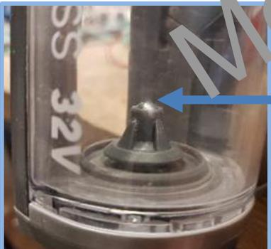
Motorspindel dreht sich nicht? Überprüfen Sie die Schraube in der Mitte der Motorspindel. Wenn sie lose bzw. nicht korrekt eingesetzt ist, fordern Sie den Kunden auf, sie festzuziehen und anschließend zu überprüfen, ob sich die Motorspindel dreht.
